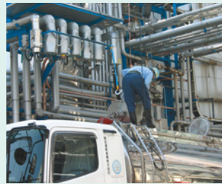
▲タンクローリーの上で作業をおこなう場合、作業者は腰にロープをつなぐことで、万一の転落事故を防いでいます
