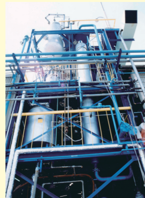
ループリアクター S系釜 最高圧力 9MPa 最高温度 240℃
