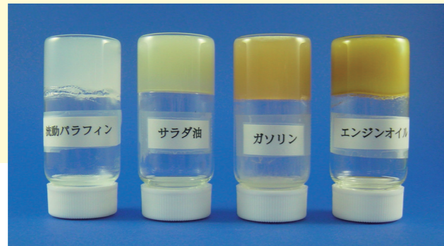
写真-3 固化したオイルの状態
