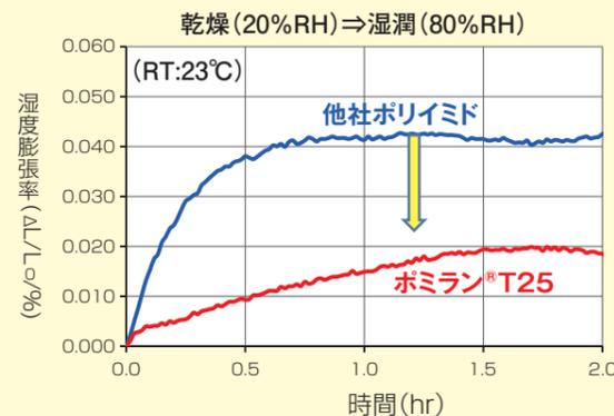
図-2 ポミランの吸湿寸法変化
