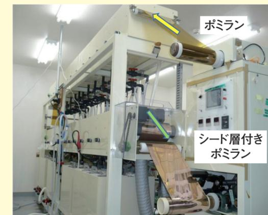
図-6 ポミラン用ロール・トゥ・ロール湿式めっき装置
