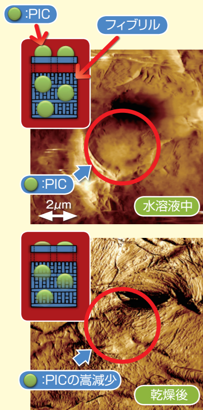
図-6 PICの乾燥前後の状態変化 *乾燥前後で全く同じ場所を観察 (SPM: Phase Image)
