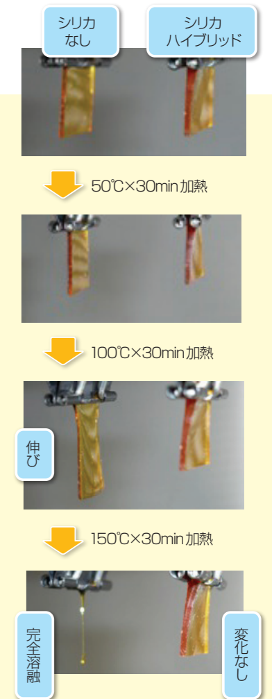
図-6 コンポセランH802から得られる硬化膜の耐熱性
