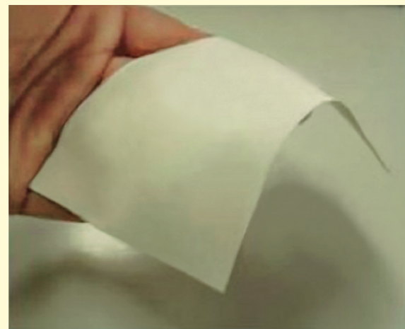
図-4 シリコーン-シリカハイブリッドをバインダーに用いた熱伝導シートの作製例
