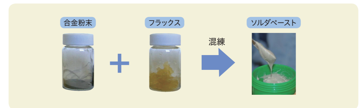
図2 ソルダペースト構成
