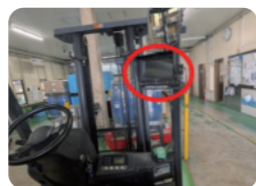
フォークリフトにAI感知カメラを導入
