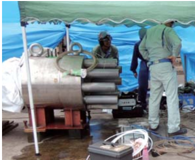
熱交換器の水浸UT検査（非破壊検査）
