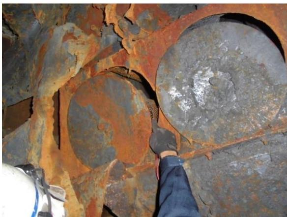
図 51 集じん機と接地極間の抵抗測定の状態
