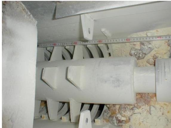
図 43 スクリューコンベア先端の解砕機（北固化室，発災前）
