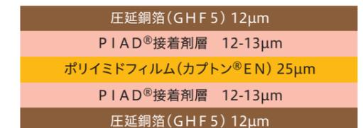
図4 FCCL評価用サンプル構造
