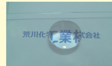
図-8 レンズ状に成型したハイブリッド硬化物
