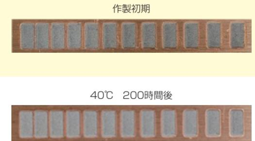
図-10 はんだペーストの加熱ダレ性試験 (JIS3284に準拠)
