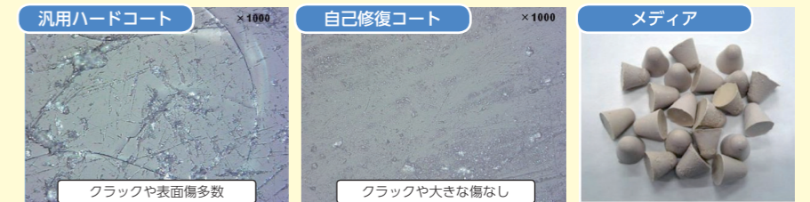
サンプル作製：ポリカーボネート板 膜厚10μm塗工品 チップング試験条件：(株)チップトン製ZC10(プラスチックメディア 10mm)
